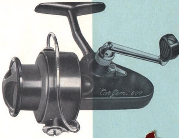
Mulinello da tutta pesca munito di due bobine di grande capacità. Movimento differenziato, cuscinetto a sfere schermato, vite senza fine con biella a braccio oscillante. Parti completamente costruite in acciaio al cromo-nichel e bronzo. Avvolgimento del filo a sistema incrociato onde evitare ogni possibilità di groviglio sia nell'uscita che nel recupero. Frizione di grande sensibilità, stabilità perfetta.
